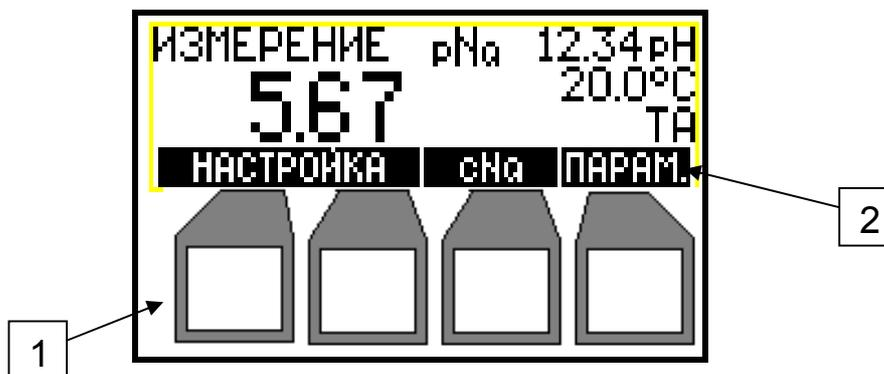
**Рисунок 2 - Дисплей и панель управления**
